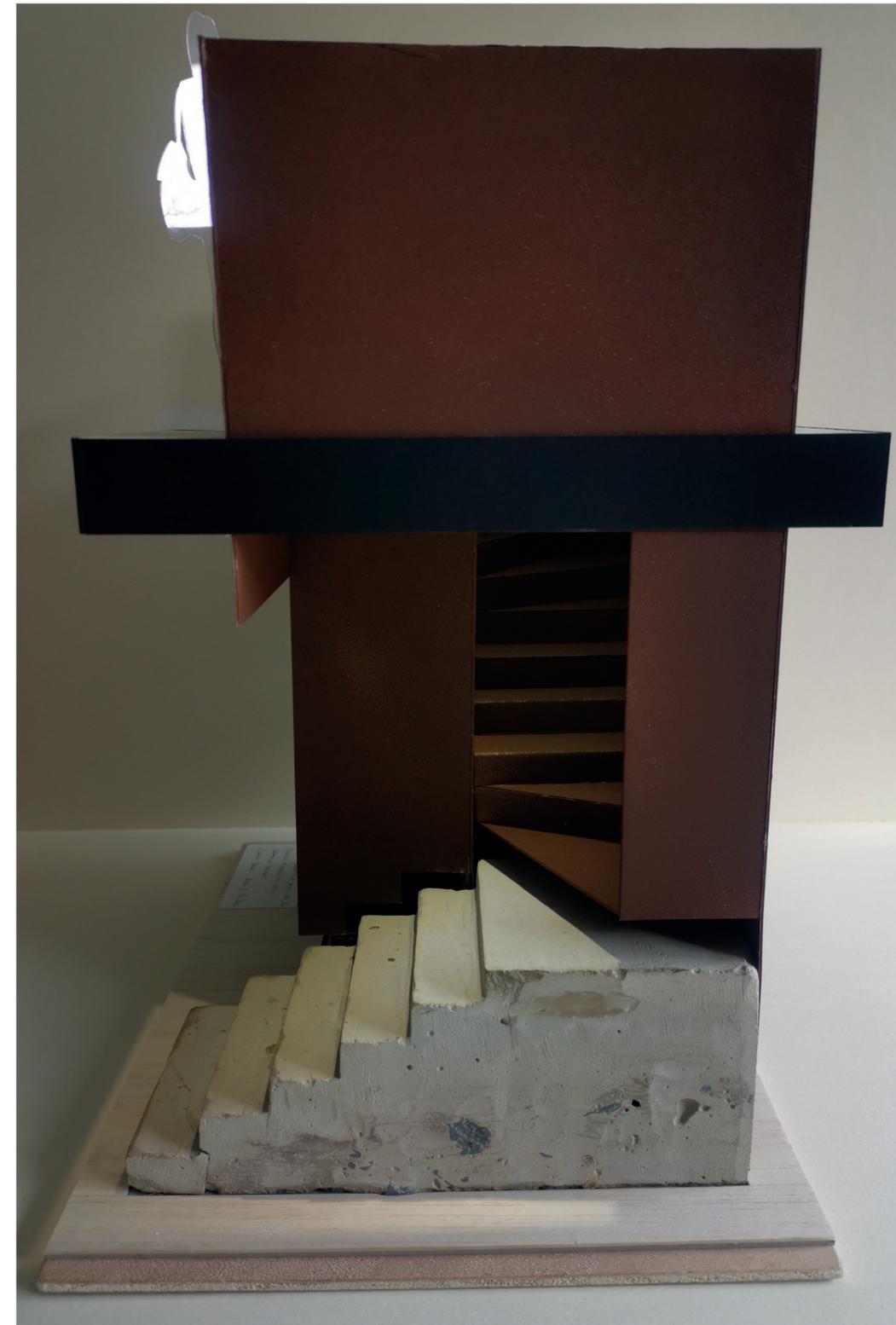
Maquette de détail de l'escalier en béton/ pierres et corten - éch. 1/10 (Cf. projet de tranformation de l'étable pages 13-15)
